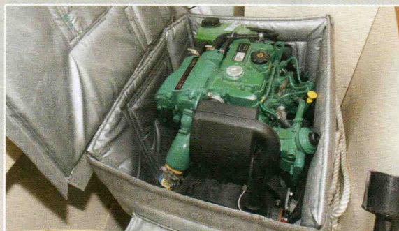
▲ Surprise, le Volvo n'est pas dans la cale mais dans un coffre de cockpit. Son cocon se révèle insuffisant en terme d'isolation.
