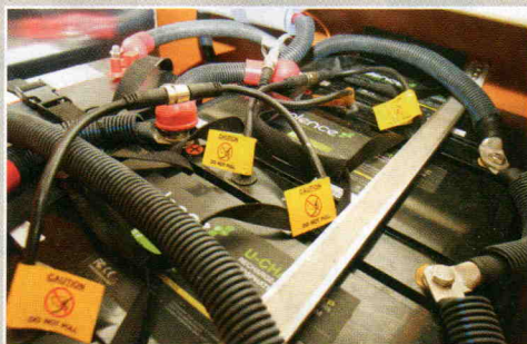
▲ Un « petit » rack central de trois batteries réservé au service est rechargé par l'éolienne.
